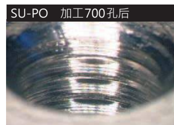
进刀处表面粗糙度 Ra=2.0μm
