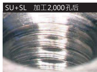
进刀处表面粗糙度 Ra=1.1μm
