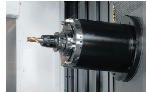
长寿命油雾润滑方式 (所有主轴)
