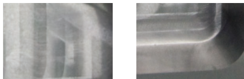
底面 侧面 进行精加工也不会加工面上留下加工痕迹
